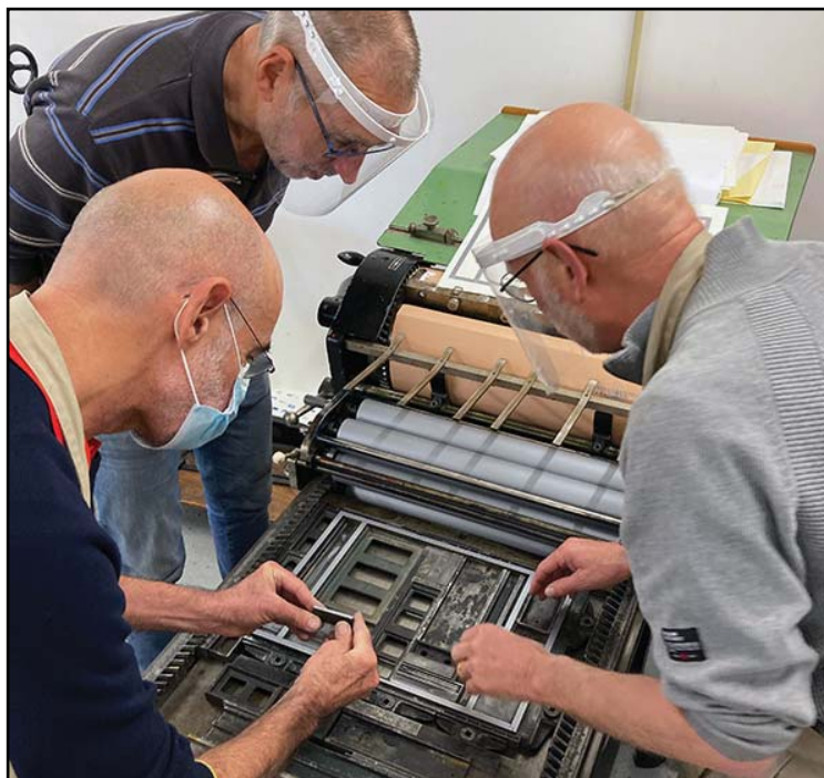
De drukvorm wordt zeer nauwkeurig op stand gezet op de drukpers.
